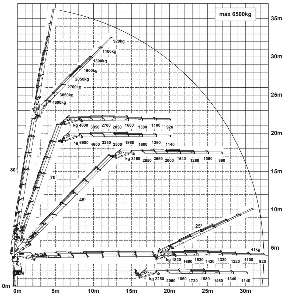
Die Tragkräfte laut Diagramm verringern sich bei Verwendung von mechanischen Verlängerungen um deren Eigengewicht.
